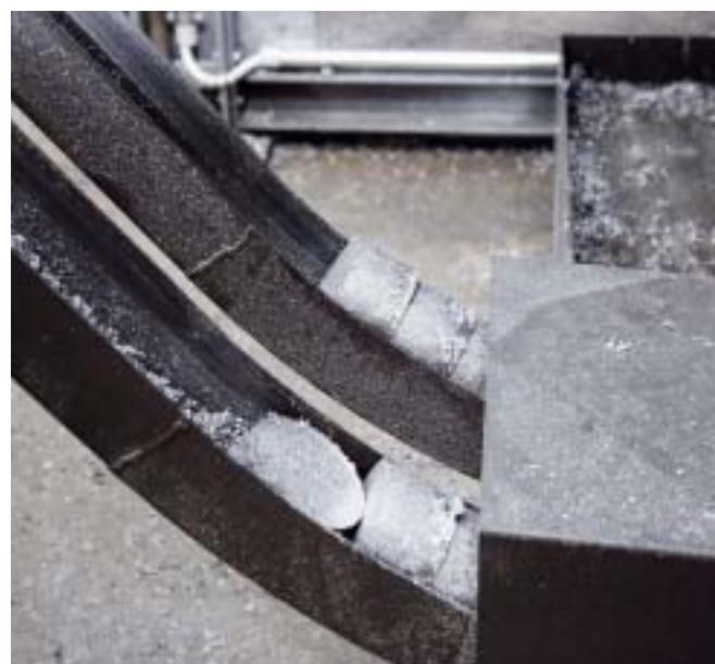
Das Volumen der Produktionsabfälle wird durch das Pressen auf einen Bruchteil des Volumens der losen Späne reduziert. Die Spänebriketts haben entweder Zylinder- oder Quaderform
