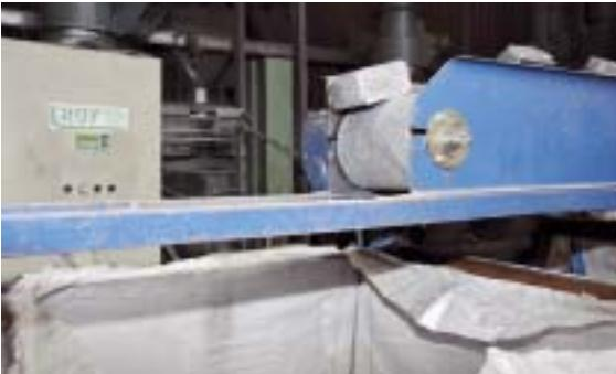
Förderbänder transportieren die Briketts von der Presse in einen von zwei Auffangbehältern. Ist der erste gefüllt, schaltet das Förderband auf den zweiten Behälter um.
