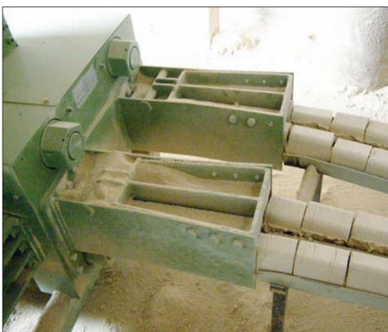
Nach dem Ausstoß aus der Anlage bricht eine Vorrichtung die Briketts in zwei Teile...
