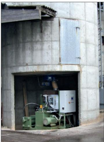
Ein bestehendes Betonsilo wurde reaktiviert, um die Schleifstäube und Sägespäne aufzunehmen, die in der Brikettierpresse (unten) verarbeitet werden.
