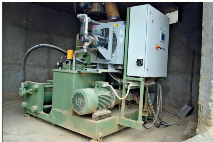
Die Brikettieranlage „Ruf 400“ erzeugt hochdichte Briketts aus den Produktionsresten des Türenherstellers. Damit wurde der Wirkungsgrad und die Effizienz der Dampfturbine gesteigert und der Ascheanfall reduziert. Die Anlage ist mit den anfallenden Holzresten noch nicht ausgelastet. Fotos: Ruf (5)
