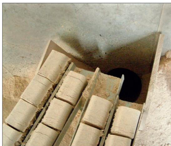
... und lässt diese durch einen Schacht nach unten auf einen Kratzförderer fallen.
